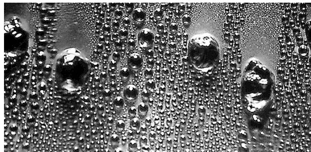
Die Erkenntnisse sollen für die Weiterentwicklung von bestehenden Wärmeübergangsmodellen speziell für die TK von Fluiden geringer Oberflächenspannung genutzt werden und zu einem verbesserten Verständnis beitragen, wie für diese Kondensationsform ein besonders effektiver Wärmeübergang erzielt werden kann.
